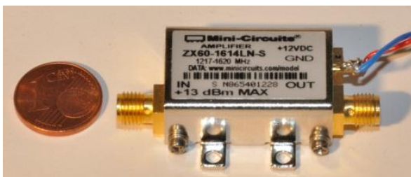
Abb. 3: LNA ZX60-1614LN mit 13dBm Verstärkung
